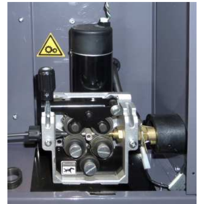
Entraînement à 4 galets 4-roller wire feeder
